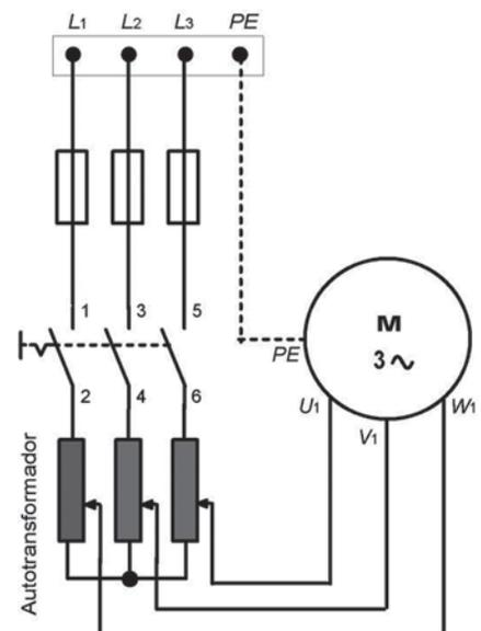
Fig. 11.13. Arranque de un motor trifásico mediante autotransformador.
