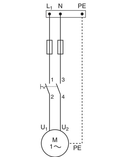
Fig. 11.24. Esquema de conexiones para la puesta en marcha de un motor monofásico de corriente alterna de forma manual.
