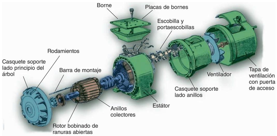
**Fig. 11.15.** Despiece del motor de rotor bobinado.
