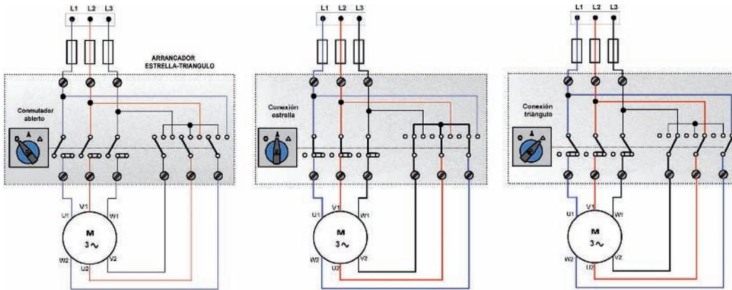
Fig. 11.11. Arranque estrella triángulo de un motor trifásico mediante arrancador manual.
