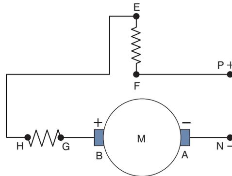
Fig. 11.30. Esquema de conexiones del motor universal.
