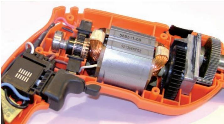
Fig. 11.31. Motor monofásico universal para un taladro eléctrico.
