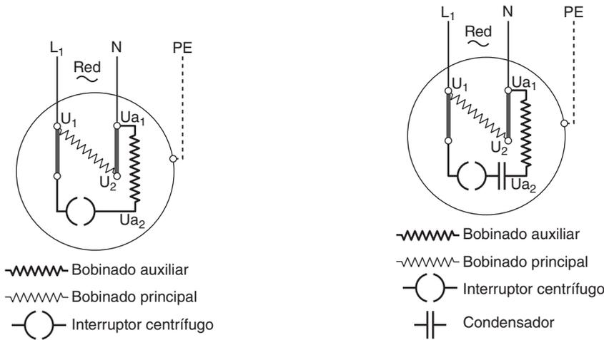
Fig. 11.22. Esquema de motor monofásico con bobinado auxiliar.
