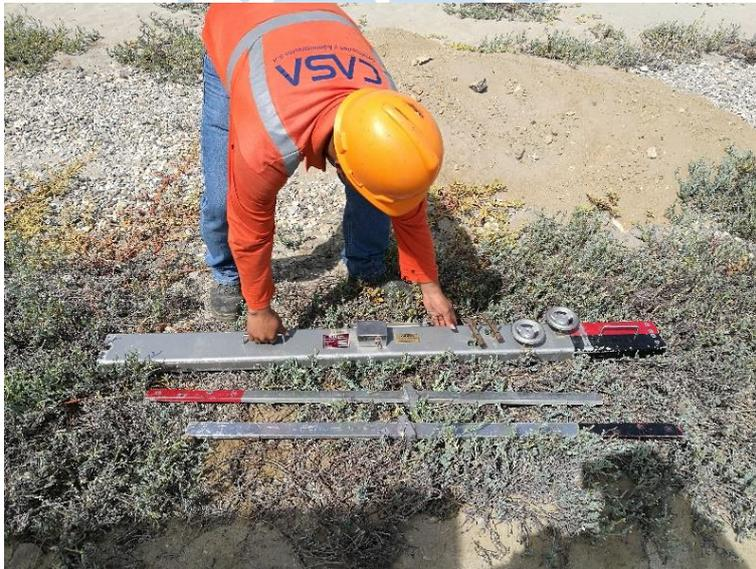
**Figura 34. Instalación de viga Benkelman en campo para comenzar el ensayo.**
