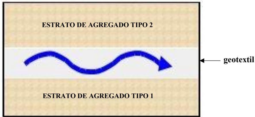
**Figura 3. Drenado de fluidos o gases a través del geotextil.**
