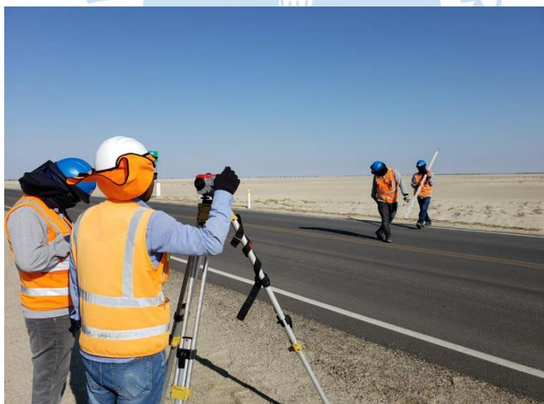
**Figura 46. Toma de datos en campo en la nivelación topográfica.**
