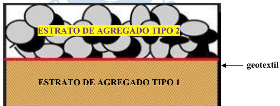
**Figura 1. Función de separación entre dos estratos que cumplen los geotextiles.**
